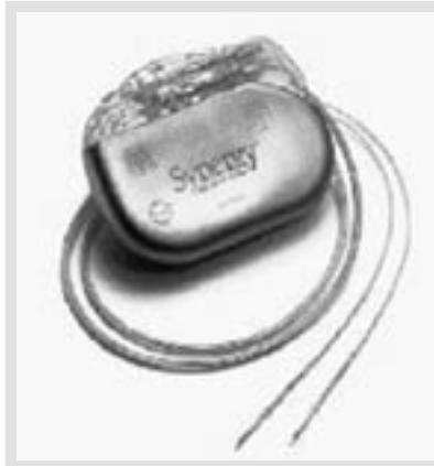
Obrázek 2. Implantabilní generátor (IPG)
